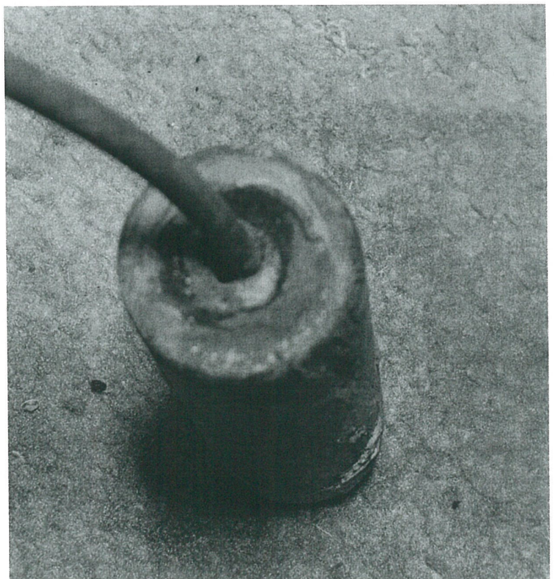
Foto 14. W-16. Radinys 2. Tas pats. Įpresuotas bikfordo šniūras. Foto V. Žulkaus
