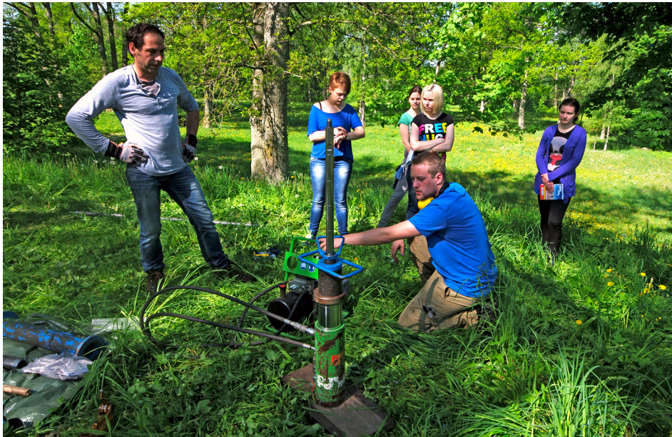
5. Hidrauliniu domkratu traukiamas kalamasis zondas iš ŠR.
