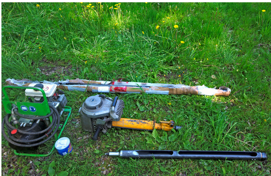
3. Mechaninio grėžimo komplektas ant didžiojo (R) pylimo.
