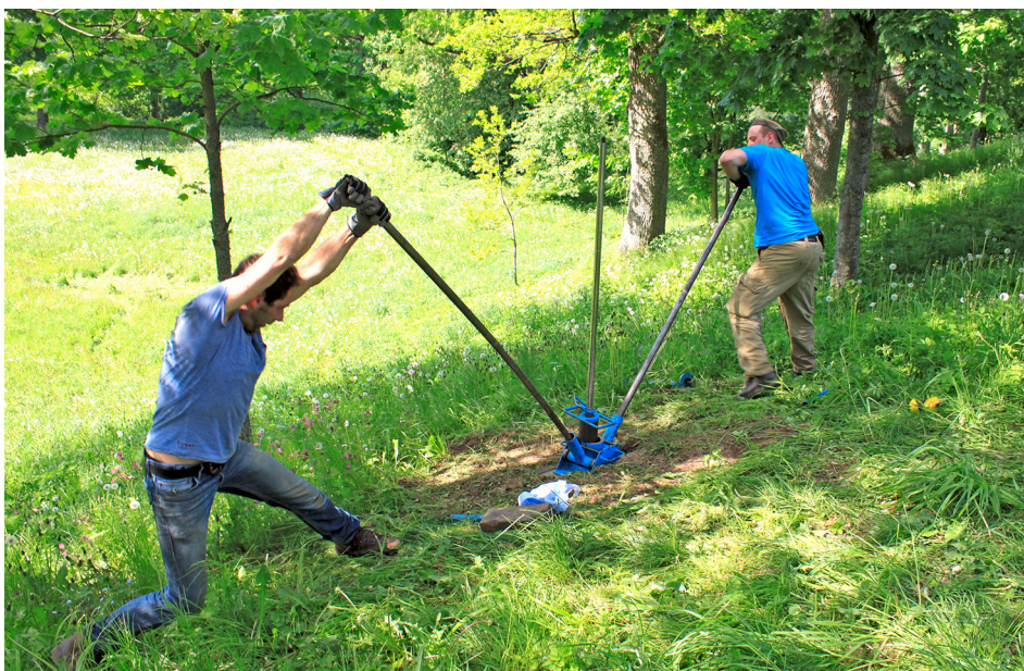
6. Mechaniniu domkratu traukiamas kalamasis zondas iš PR.
