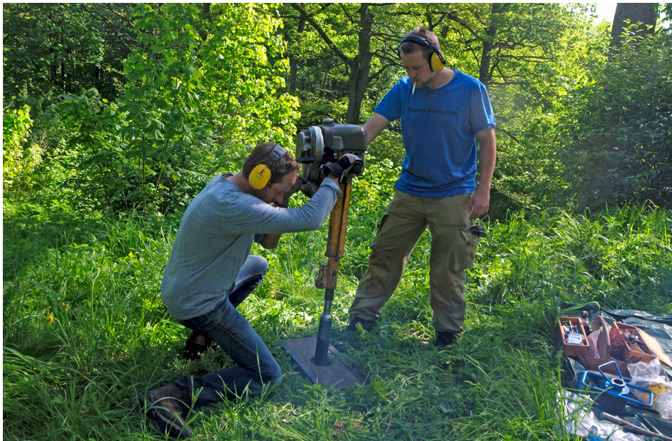
4. Kalamas zondas motoriniu kalikliu iš ŠV.
