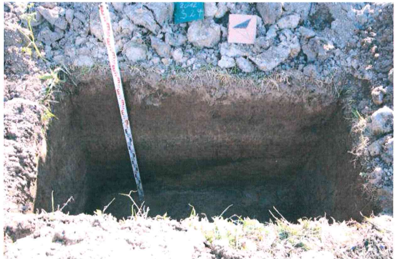
Fot. 41. Šurfas Nr. 23, bandomasis zondas (foto iš V)
