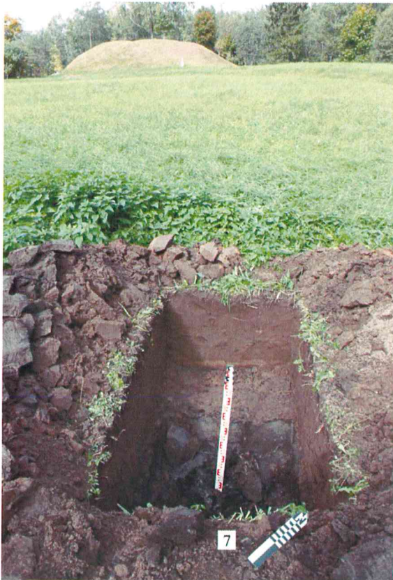
Fotografija Nr. 14 Bendras iki gruntinio vandens lygio iškasto šurfo Nr.7 vaizdas su išgręžtu gręžiniu iš PR pusės.
