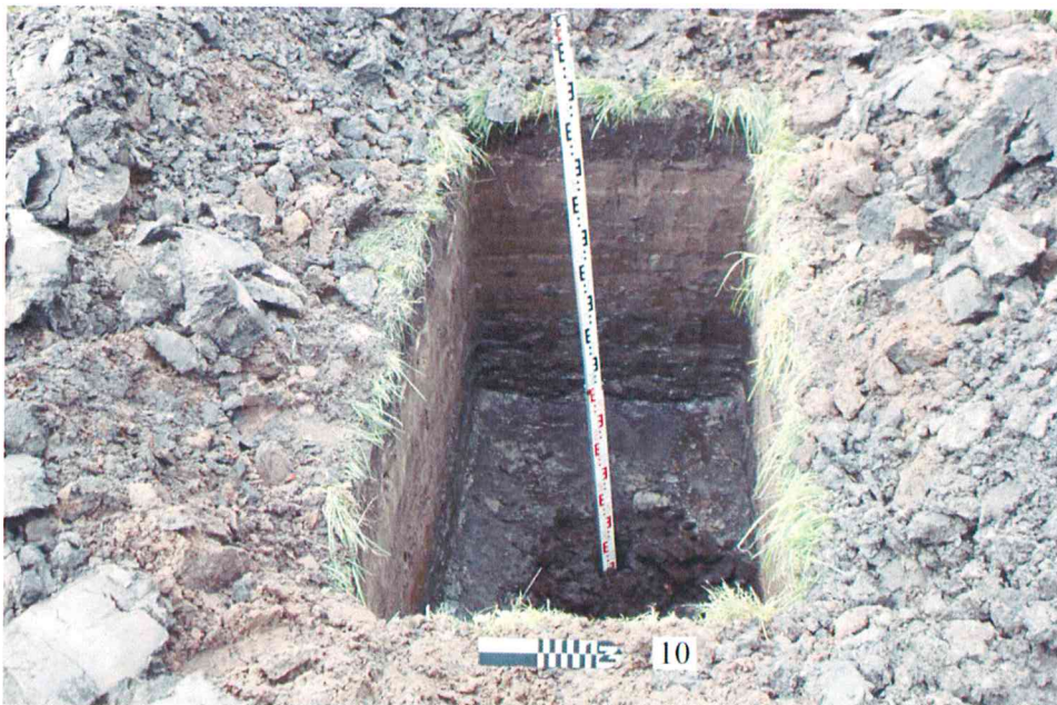
Fotografija Nr. 20 Bendras iki gruntinio vandens lygio iškasto šurfo Nr.10 vaizdas su išgręžtu gręžiniu iš R pusės.
