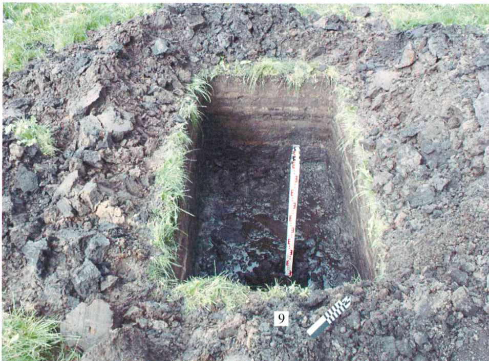
Fotografija Nr. 18 Bendras iki gruntinio vandens lygio iškasto šurfo Nr.9 vaizdas su išgręžtu gręžiniu iš PR pusės.
