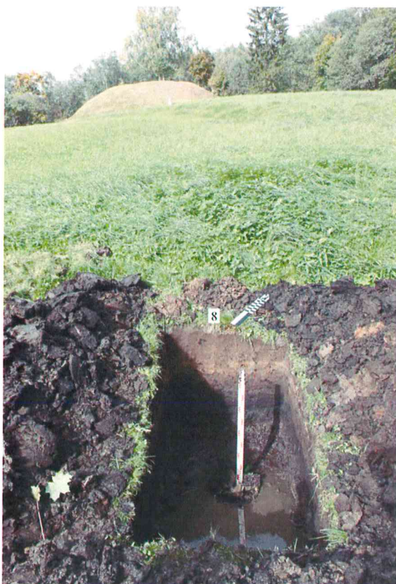
Fotografija Nr. 16 Bendras iki gruntinio vandens lygio iškasto šurfo Nr.8 vaizdas su išgręžtu gręžiniu iš PR pusės.
