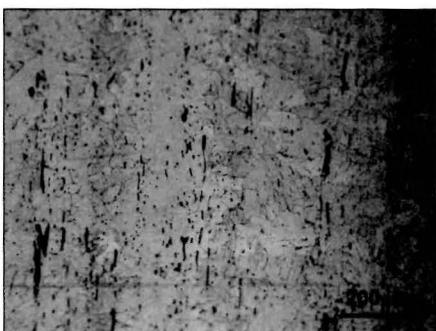
31 pav. Bandinio Nr. 18 mikrostruktūra. Kalimo metu deformuoti šlako intarpai (tamsiai pilki) geležyje. Ėsdinta 3%  $\text{HNO}_3$  titrui etanolyje. Nuotrauka A. Selskienės.
