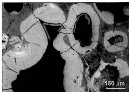
14 pav. Bandinio Nr. 4 mikrostruktūra. Poros (juodos) iš dalies užpildytos geležies korozijos produktais (šviesiai pilki). Nuotrauka A. Selskienės.
