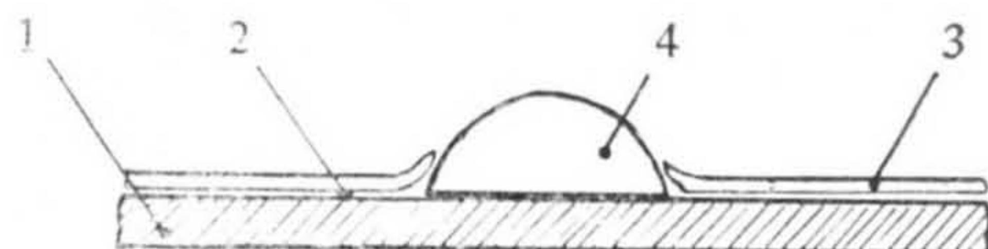
22 pav. Kryžinio smeigtuko (pav. 21) akučių tvirtinimo schema
