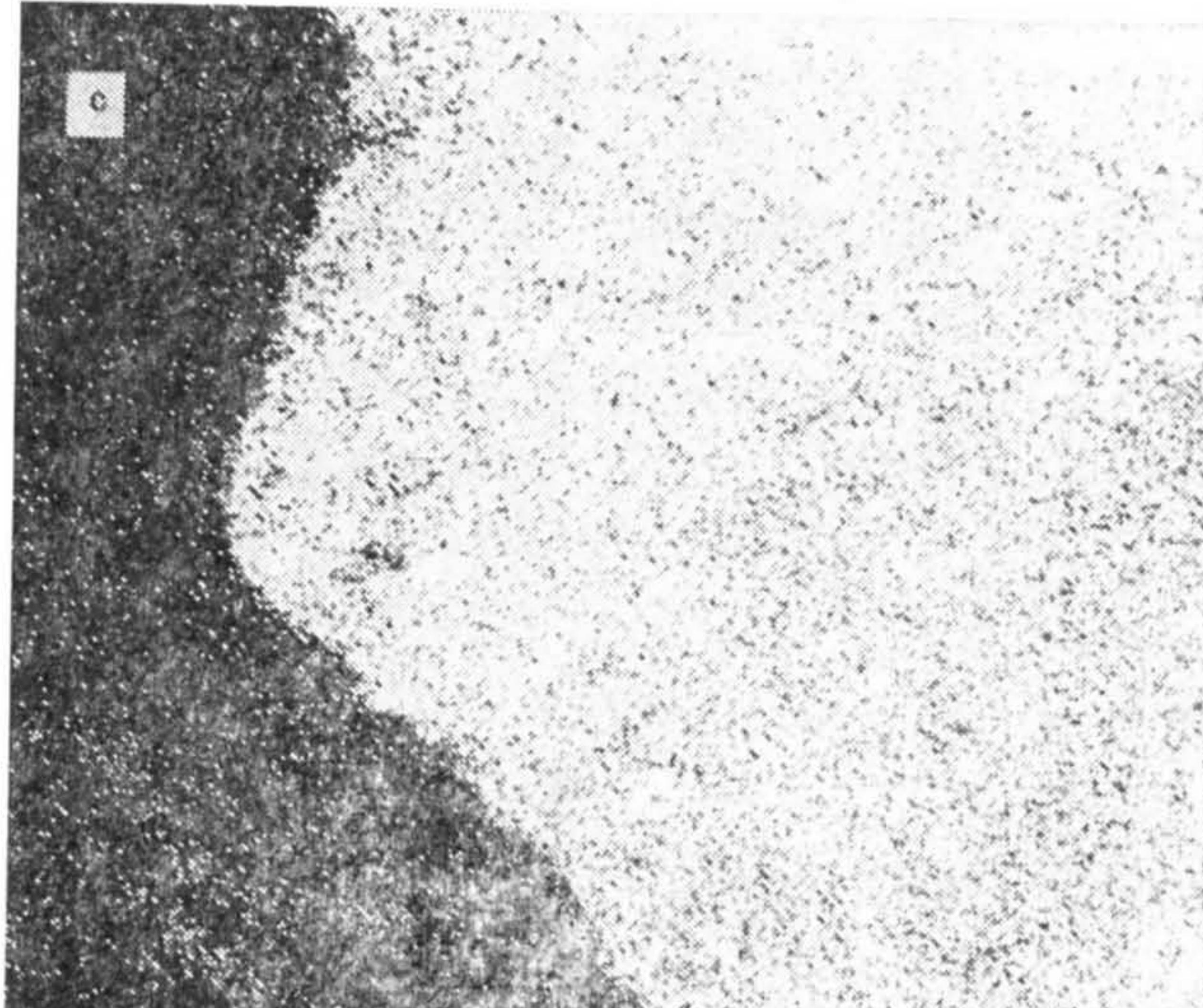
20 pav. Kryžinio smeigtuko (pav. 19) pjūvis (padidinta 500 kartų): a — bendras vaizdas, b, c — pavienių elementų išsidėstymas, gautas charakteringuose rentgeno spinduliuose; b — sidabras, c — alavas
