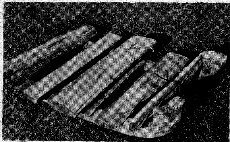
5. Бескопыльные сани ( kivikelk ) для камней с полозьями из копани. 1972 г. Эстонская ССР, Кохтла-Ярвеский р-н, Люганузе. ЭФ
